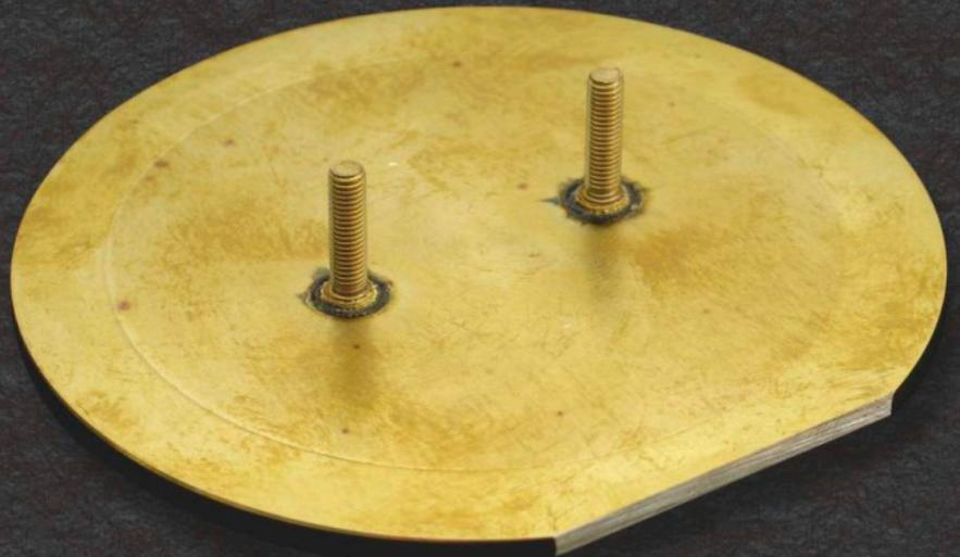
Gewindebolzen mit Präzisions-Bolzenschweißgerät angeschweißt.
